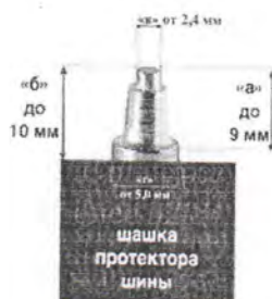
Схема требования к шипам заднего колеса для классов Спорт МХ-1, Спорт МХ-2, Китайский класс
