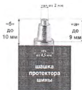
Схема требования к шипам переднего колеса для классов Спорт MX-1, Спорт MX-2, Китайский класс
