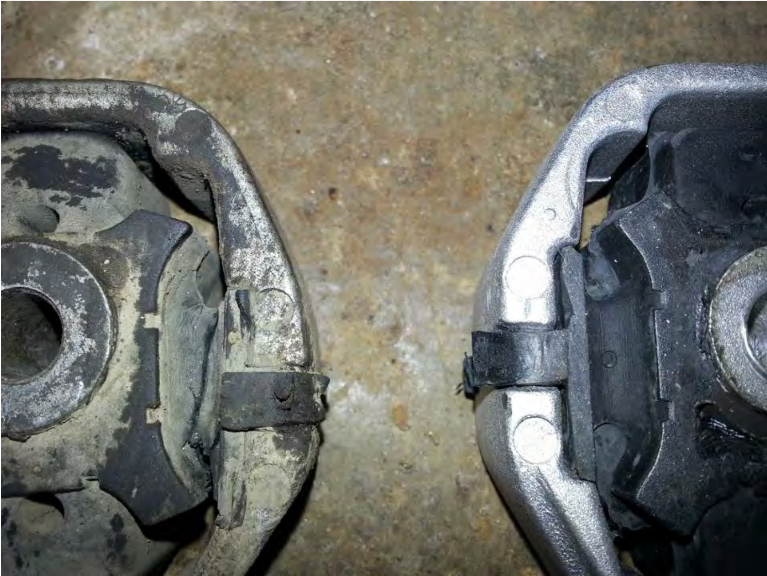
Снятие передней рамы и замена сайлентблоков
