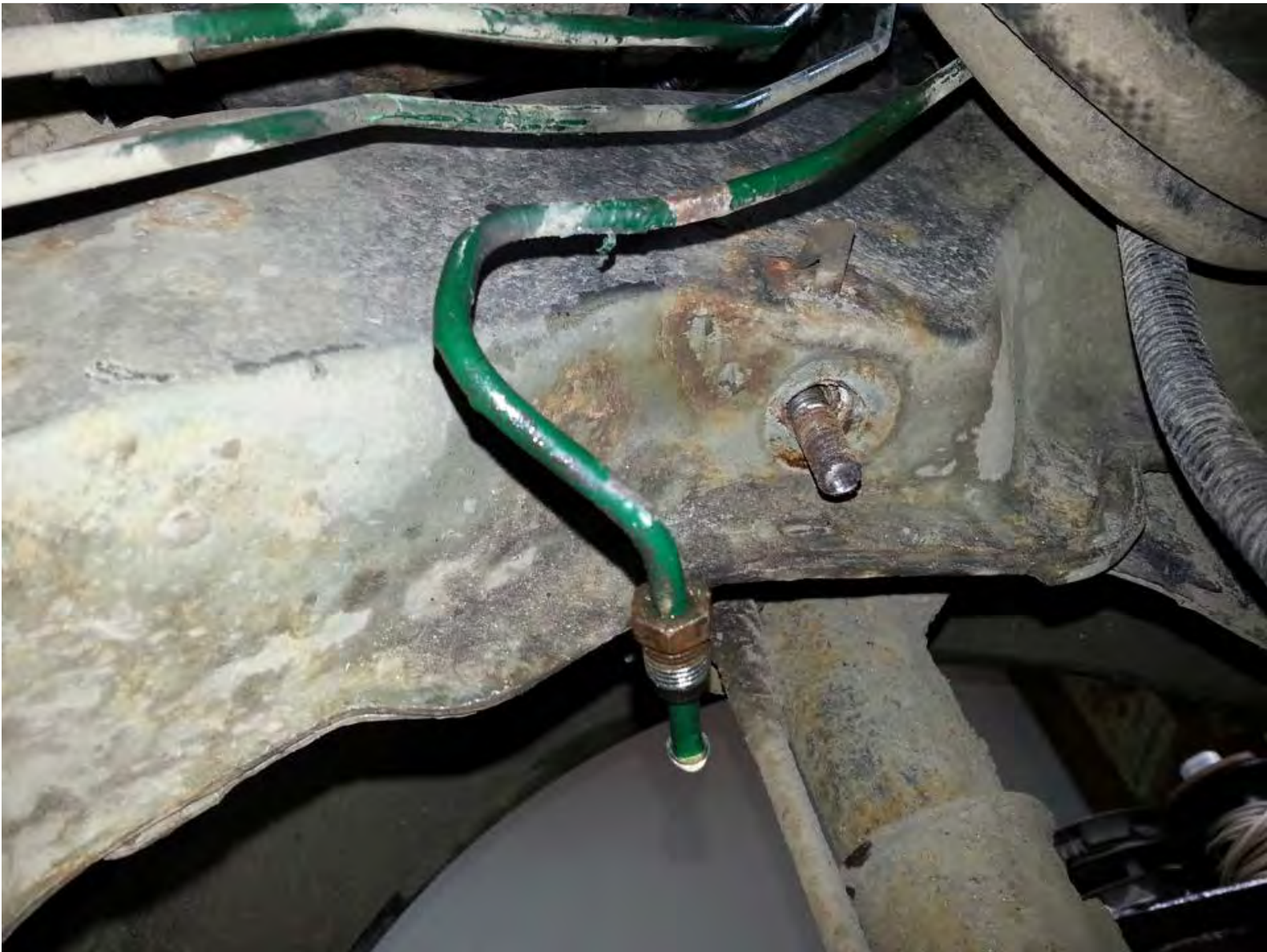
Откручивая балку — сломали болт
