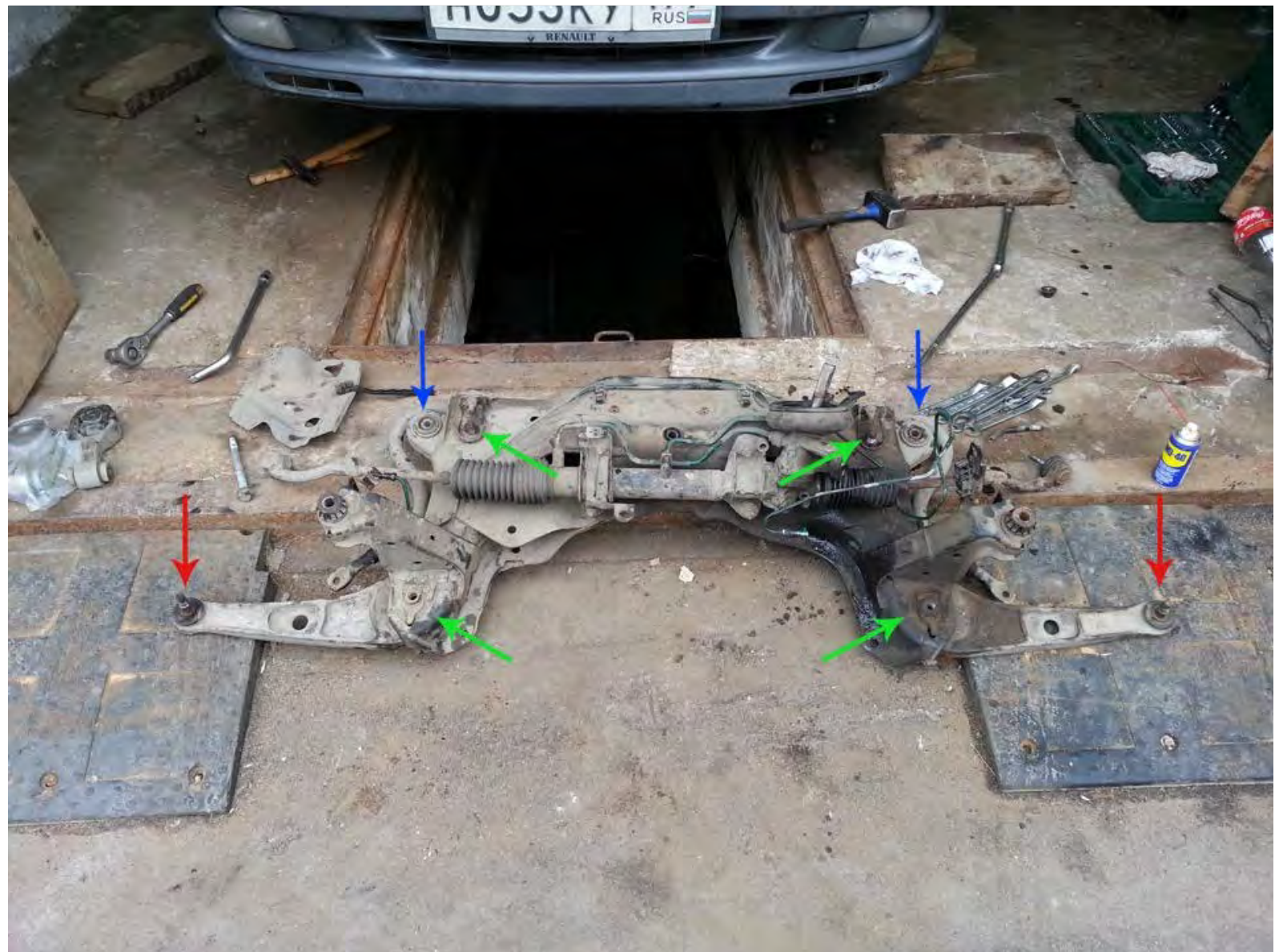
Красным — шаровые, Зеленым — сайлентблоки рычага подвески, Синим — сайлентблоки рамы
