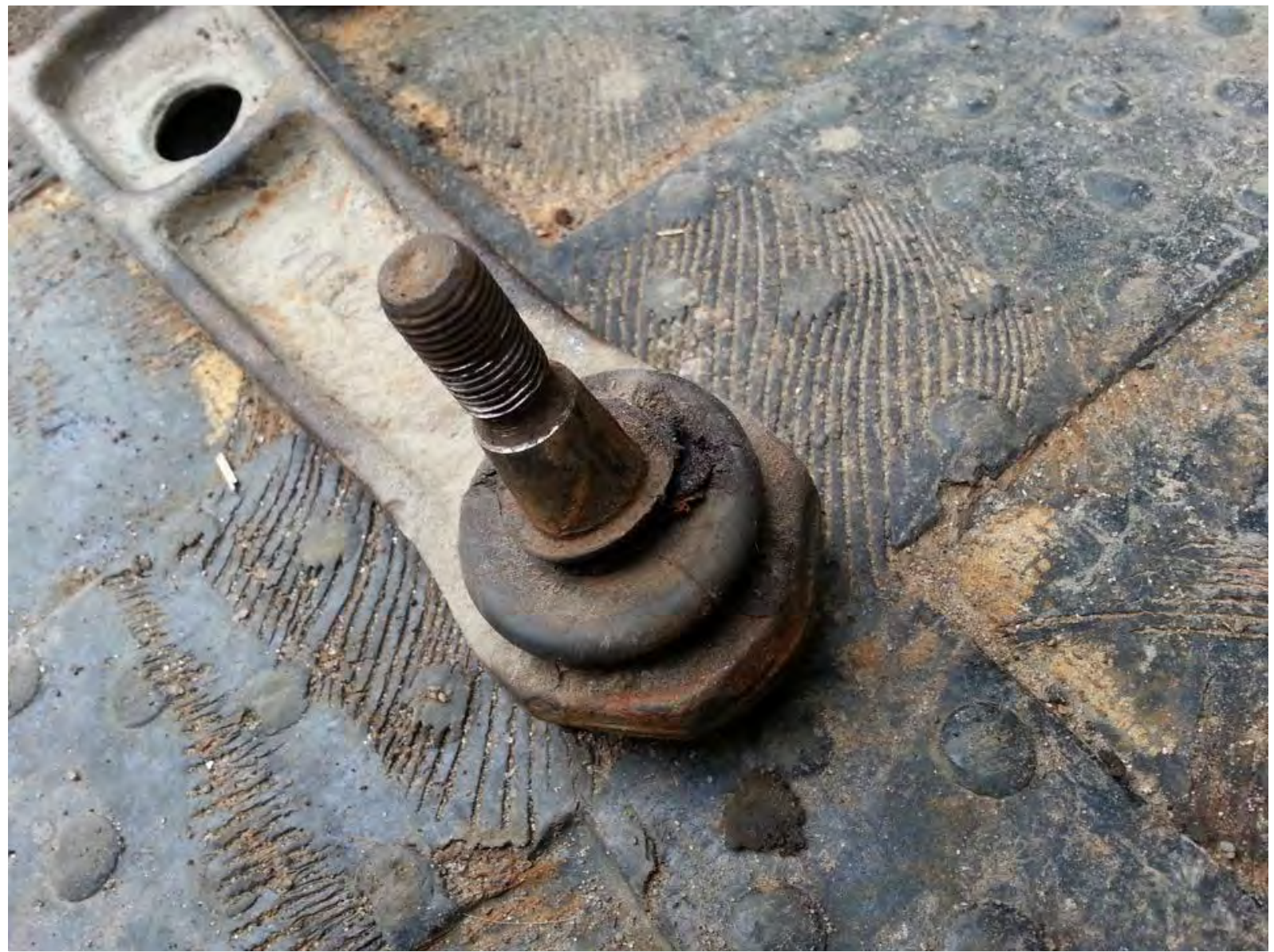
Снятие передней рамы и замена сайлентблоков
