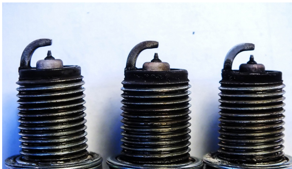
слева на право: 2–3–4 цилиндр, на 4-м сажа добралась до изолятора
