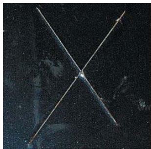
Автомобиль с холодной оцинковкой (толщина слоя 10 мкм)
