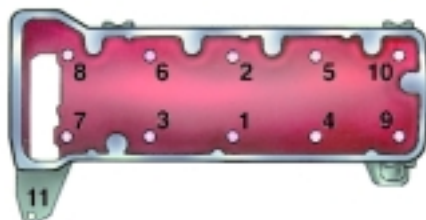
Рис. 2-2. Порядок затяжки болтов крепления головки цилиндров двигателя мод. 2106–70
