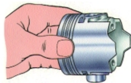
Рис. 2–76. Проверка посадки поршневого пальца двигателя мод. 2106–70
