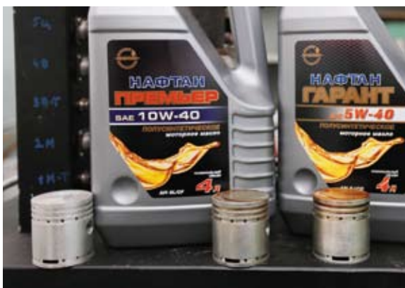
Масла прошли испытания на моющие свойства, образец чистого поршня — слева
