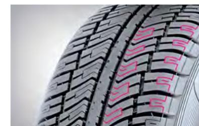
Тонкие ножевые прорезы, предусмотренные для повышения защиты от аквапланирования, способствуют разделению водяной пленки.
